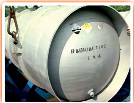
Основний попереджувальний знак на резервуарі.
